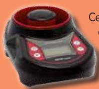
Cet appareil se caractérise par une utilisation simple et un affichage rapide et précis des résultats de la mesure. Convient pour la détermination de l'humidité des fruits à grains agricoles avec beaucoup des cultures programmées (blé, orge, colza, maïs...) Chambre de mesure très robuste en métal et boîtier en plastique ABS de haute qualité. Affichage graphique avec rétroéclairage à LED. Port USB pour les mises à jour logiciel.
