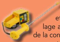
Appareil de mesure numérique pour l'humidité et la température du foin, de la paille et de l'ensilage avec une sonde de 68 cm. Il mesure les variations de la conductibilité électrique des matières et les convertit en pourcentage d'humidité. Possibilité de stocker 50 données.
